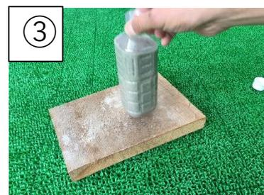
③ 軽く地面に打ち付け、砂を容器底部側に詰めます。
