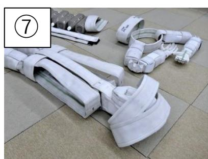
残りの胴体の横方向の部品を頭側に抜きます。
