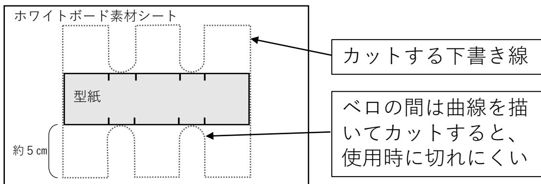
\*めくり用シートは、13ページの写真的形状を参考にしていただき、お好きな大きさでカット後、表示シートに切り込みを入れ、表示シート裏面から差し込みボンド等で固定します。
