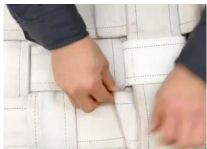
③前後それぞれ3カ所のベロをホースの隙間に挿入し、固定します。
