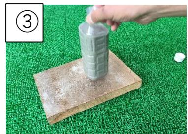
地面にペットボトルの底を数回打ち付け、砂を容器底部側に詰めます。
